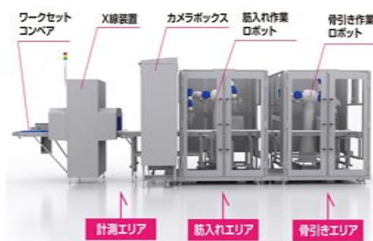
【X線三次元画像処理豚部分肉自動脱骨装置】
